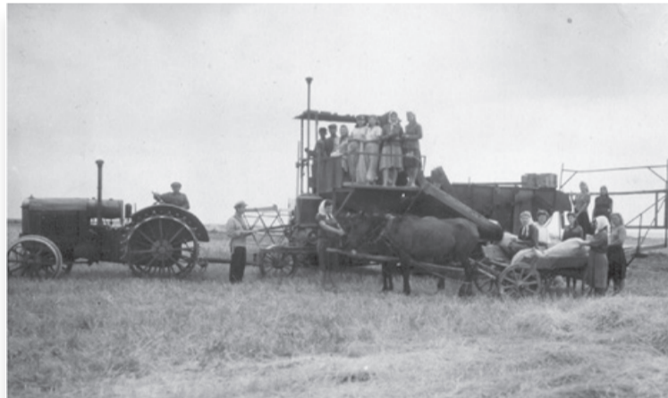
ТРАКТОР СТЗ с прицепным комбайном «Коммунар». Такая техника работала в совхозе «Вперед» в 1930-х — начале 1940-х годов
