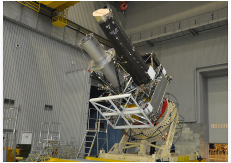
ТЕЛЕСКОПЫ ART-XC (Россия) и eRosita (Германия) в сборе
