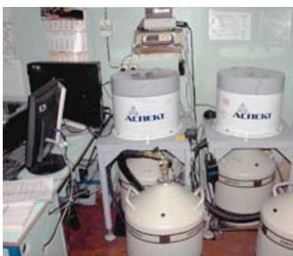
Детекторы гамма-спектрометрических комплексов с низкофоновой защитой и перекачивающей системой для жидкого азота
