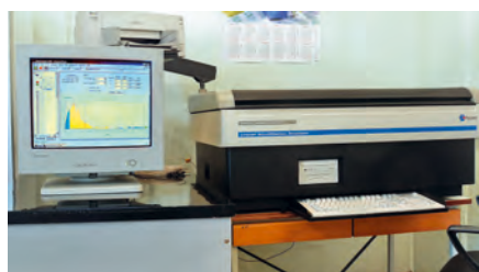
Проведение исследований на жидкостно-сцинтилляционном радиометре
