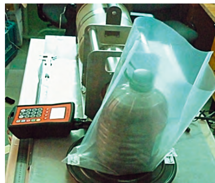
Измерение проб грунта на гамма-спектрометрическом комплексе ISO-CART
