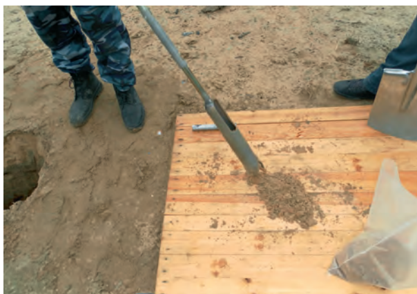
Извлеченная проба грунта
