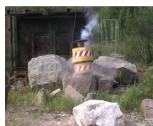
Раскалывание гранитного блока размером 100x150x200см
