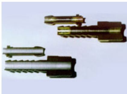
Образцы с нанесенным антикоррозионным покрытием: гальваническое кадмиевое (вверху), диффузионное цинковое (внизу)
