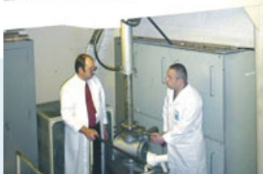
Высокотемпературный стенд для получения полых микросфер (защищен патентами РФ)
