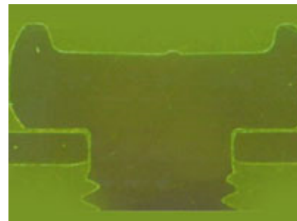
Сечение болта с невыпадающей шайбой. Диффузионное цинковое покрытие точно повторяет контуры детали
